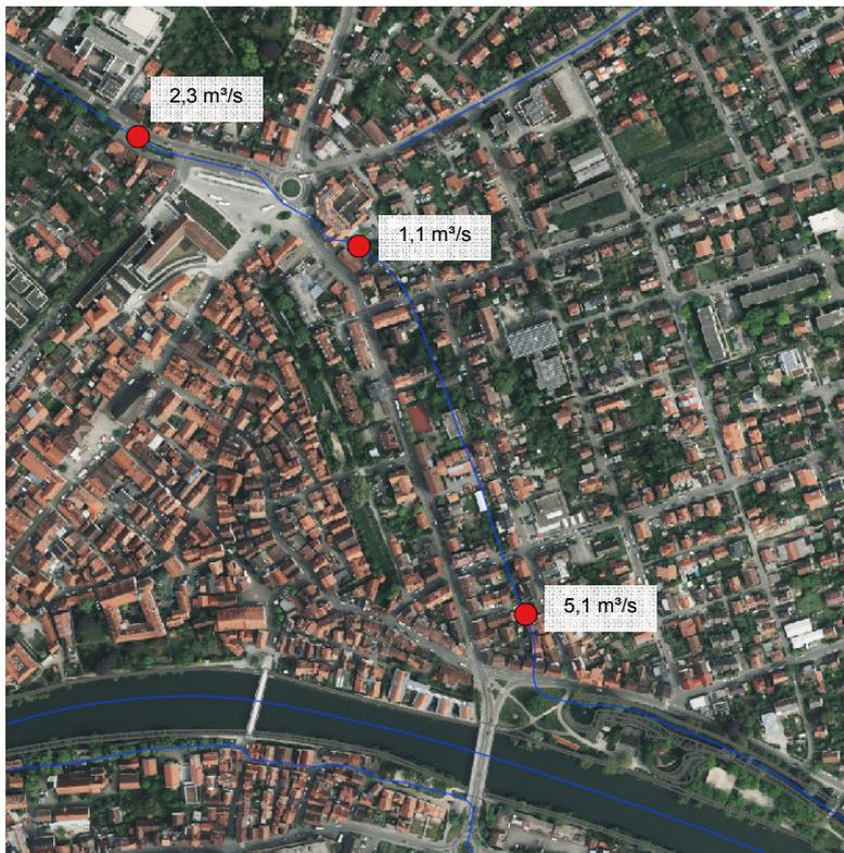
**Abb. 1:** Oberflächlicher Abflussanteil bei  $HQ_{100}$  am Weggentalbach
