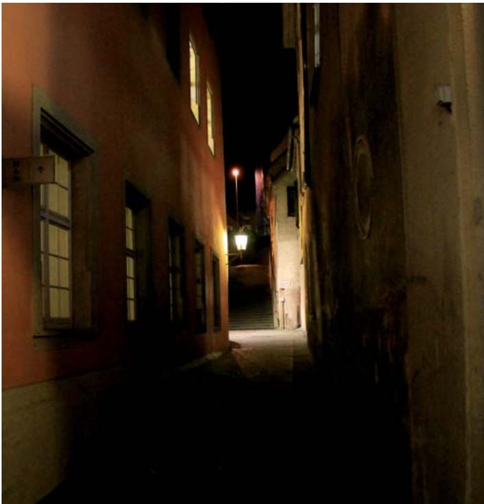
Das Lichtniveau in vielen Gassen ist durch eine ungünstige Leuchtenanordnung zu niedrig. Teils bedingt durch stark verwinkelte Gassenführung oder aber durch fehlende Leuchtenstandorte.
