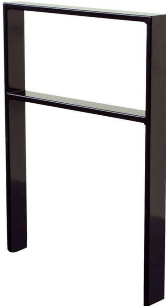
11. Handläufe: Flachstahl 50 x 20 mm, mit Knieholm, verzinkt und lackiert, mit Kernlochbohrung in Stufen befestigt
