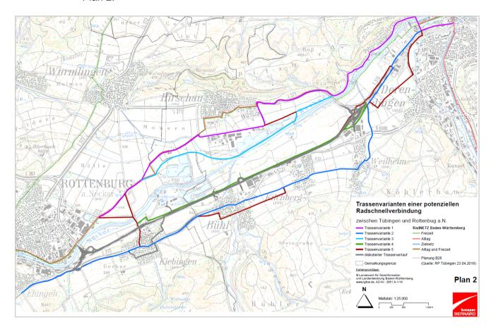
Um die aus diesem Arbeitsschritt resultierenden Trassenvarianten vergleichen und eine Empfehlung für eine Vorzugsvariante ableiten zu können, wurde der Korridor zunächst in vier Abschnitte gegliedert. Die Übergabepunkte zwischen den einzelnen Abschnitten ergeben sich an Stellen, auf denen alle denkbaren Trassenvarianten aufeinandertreffen und ein Wechsel zwischen den Varianten möglich ist.
