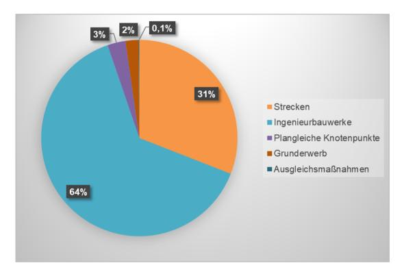
Mit 64 % tragen der Bau von insgesamt sechs Ingenieurbauwerken sowie die Instandsetzung eines Ingenieurbauwerkes in Rottenburg a.N. mehr als 60 Prozent der Gesamtkosten bei. Weitere 31 Prozent werden für Maßnahmen des Neu- und Ausbaus von Strecken zum Standard einer Radschnellverbindung benötigt. Die Kosten für möglichen Grunderwerb sowie erforderliche Ausgleichsmaßnahmen bilden mit weniger als drei Prozent einen sehr geringen Anteil an den Gesamtkosten.
