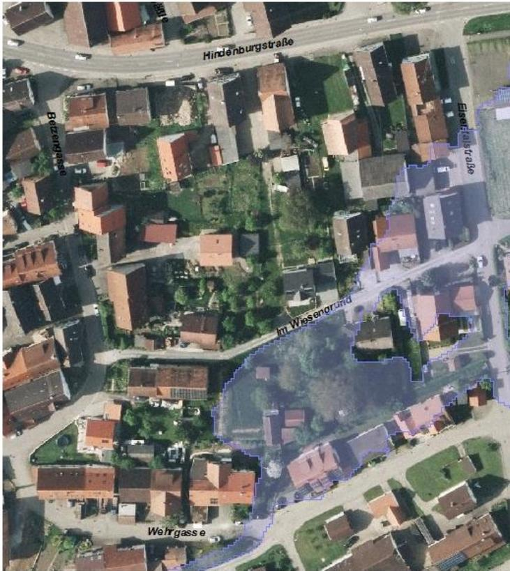
Abb. 4: Planbereich mit Überschwemmungsfläche Hochwasser HQ<sub>100</sub> (Luftbildaufnahme Frühjahr 2014)
